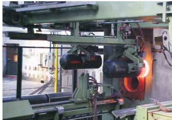
Figura 4 – Tratamento térmico em cilindro para gases (Fonte: MAT)
